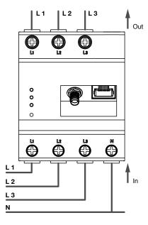
Der Betrieb des Gerätes erfolgt an Phase L1\*
